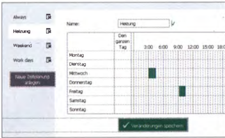
Bild 4: Die Zeitpläne ermöglichen das minutengenaue Schalten der Ausgänge.
