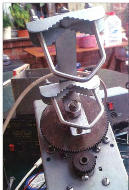
Bild 6: Der am großen Zahnrad befestigte Winkel dient als untere Masthalterung.
