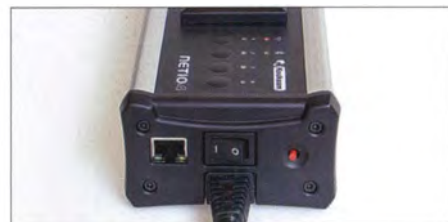
Bild 3: Auf der anderen Seite liegen Ethernet-Buchse, Netzkabel, Schalter und Sicherung.
