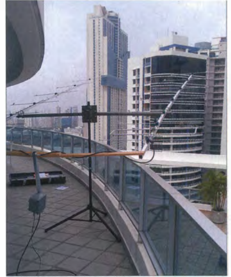
Trotz des provisorischen Aufbaus auf dem Balkon im 19. Stock wurde HP/KG7HF via Mond gehört.
