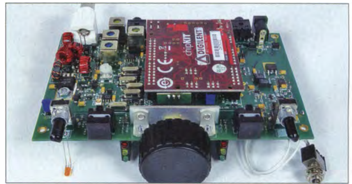
Bild 4: Auf der Oberseite der Platine sind alle Steckverbinder und Jumper zugänglich.
