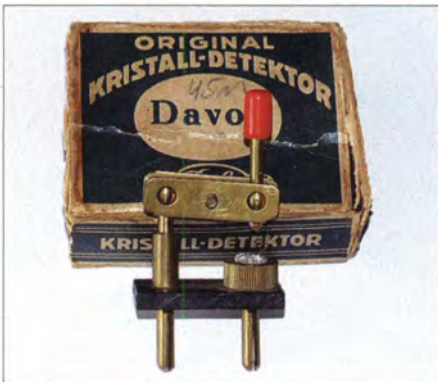
Bild 1: Mit einfachen Mitteln ließ sich ein solcher Kristalldetektor (Kristalldiode) nachbauen.
