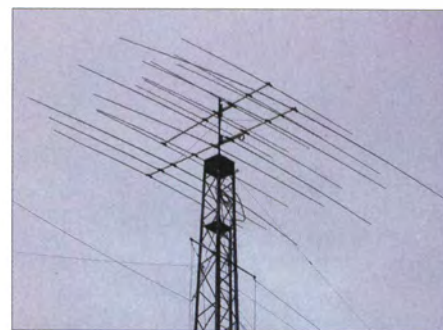
5-Band-Opti-Beam von JW5E, Sloopier für 40 m, 160 m, 80 m sowie 30-m-Dipol in 25 m Höhe
