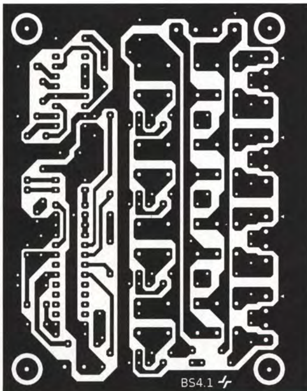
Bild 6: Layout der einseitig kupferkaschierten Platine; Abmessungen 80 mm x 100 mm, M 1:1
