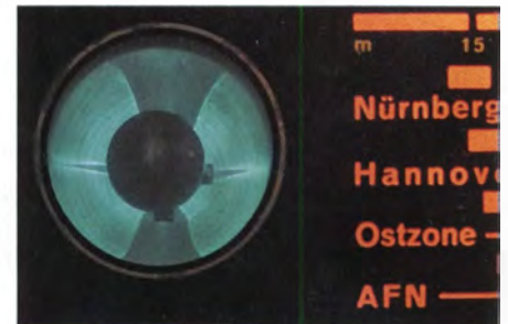
Bild 6: Aussteuerungsanzeige mit Magischem Auge, hier gezeigt am Beispiel einer EM 11; je stärker das Empfangssignal, desto größer war der Leuchtwinkel.
