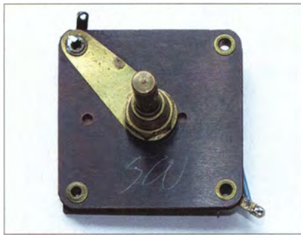
Bild 5: Solche Drehkondensatoren, auch „Quetscher“ genannt, dienten häufig zur Einstellung der Rückkopplung.
