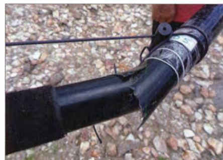
„Widrigkeit Nr. 11“ führte gleich zum Bruch von zwei Masten.
