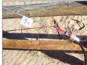
Bild 2: Eckeinspeisung der Delta-Loop mit Kfz-Steckverbindern – gewichtsparender geht es nicht!
