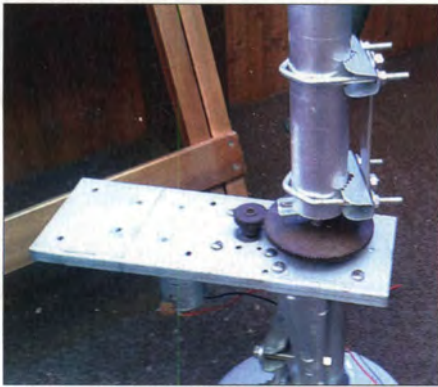
Bild 1: Ansicht des Rotors (ohne Abdeckhaube) mit eingesetztem Mast
