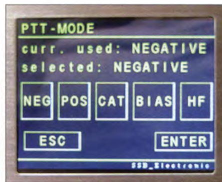
Bild 7: PTT-Modis, einstellbare PTT-Verzögerung und zuschaltbares Dämpfungsglied
