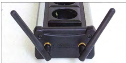
Bild 2: An einer Schmalseite werden WLAN- und Bluetooth-Antenne angeschraubt.
